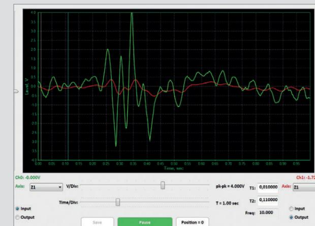
Echtzeit-Schwingungsmessung mit dem Oszilloskop
