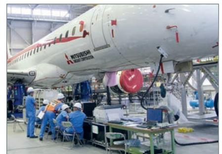
飛機測試：Fabreeka® 的軟支撐系統能讓懸浮飛機做地面振動測試
